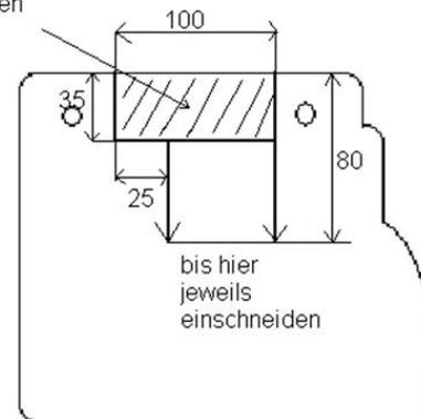
K55) An Achse 1 ist die ins Radhaus ragende Kante des Kunststoffspritzschutz in Höhe der Stoßfängeroberkante auszuschneiden.
