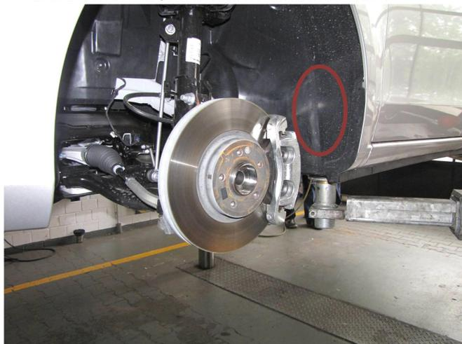
K132) Um eine ausreichende Freigängigkeit an Achse 2 herzustellen ist der Kunststoffflap der Radhauskante im Bereich der Oberkante Stoßfänger bis 50 Grad hinter der Radmitte innen um 5 mm zu kürzen.
