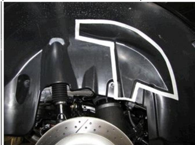
K113) An Achse 2 ist der Kunststoffinnenkotflügel im Bereich der äußeren Reifenschultern (bei Geradeausfahrt) warm nach oben einzuformen.
