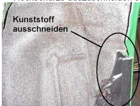
K70) Um eine ausreichende Freigängigkeit der Rad-Reifen-Kombination an Achse 2 zu gewährleisten sind folgende Maßnahmen erforderlich:
