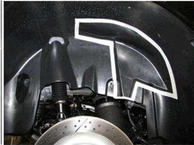
K110) Um eine ausreichende Freigängigkeit an Achse 2 herzustellen sind die vor den Stoßdämpfern befindlichen Ausbuchtungen des Kunststoffinnenkotflügels auszuschneiden.
